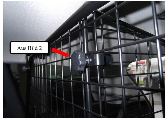
Nun den Teiler mittels der drei Verschraubungen aus Bild 2 an allen drei Positionen am Trenngitter (Pos. 1) befestigen.
