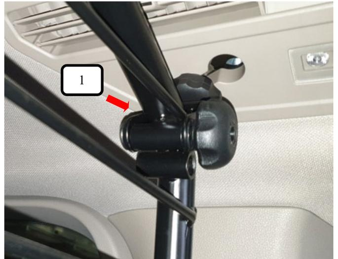
Die Montage des Trenngitter (Pos. 1) hinter der 1. Rücksitzbank, unterscheidet sich in Bild 7 + 8. An dieser Stelle muss die obere Hülse am Trenngitter (Pos. 1) genutzt werden, die Befestigung ist gleich. Die Position der Bodenhalter (Pos. 2) aus Bild 5 + 6 muss dementsprechend verschoben werden.
