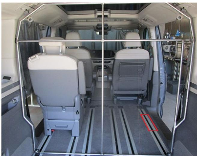
Die Ankerplatte (Pos. 8) kann nur in dem rot markierten Bereich eingesetzt werden und wie diese in das Schienensystem eingesetzt wird, sehen sie auf Bild 4.
