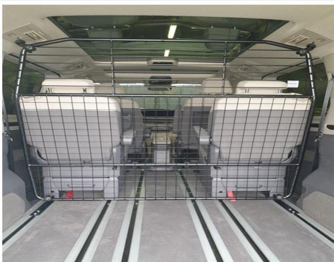
Trenngitter im montierten Zustand, hinter der 1. Rücksitzreihe.
