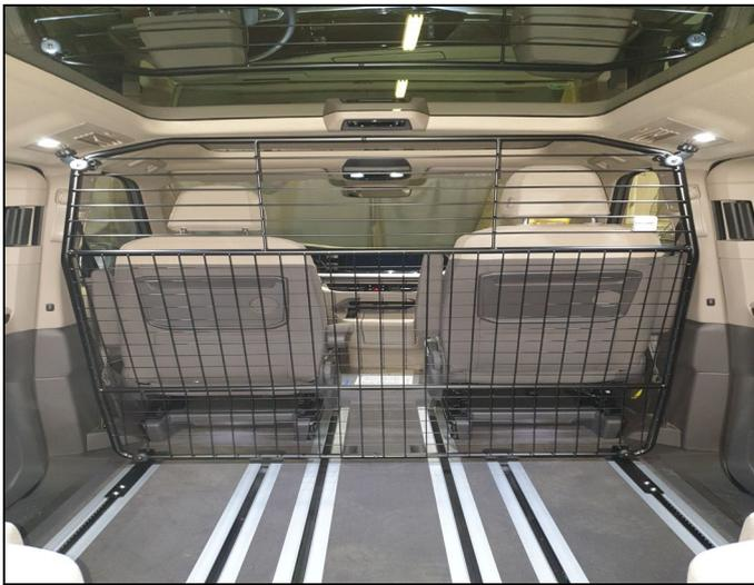
Trenngitter im montierten Zustand, hinter den Vordersitzen.
