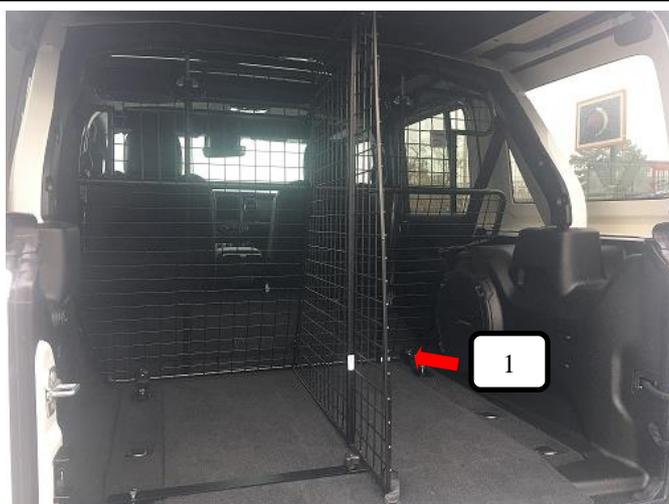
Raumteiler (Pos. 1) in das Fahrzeug einbringen.
