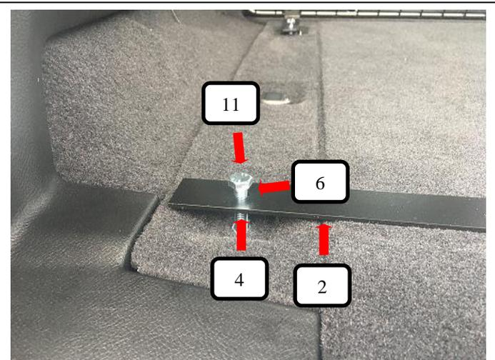
Verzurröse mit einem Torx-Dreher entfernen bzw. abschrauben. Maschinenschraube (Pos. 11) mit Unterlegscheibe (Pos. 6) durch den Bodenhalter (Pos. 2) und dann durch die Distanzhülse (Pos. 4) stecken. Jetzt die Maschinenschraube (Pos. 11) in die vorhandene Bohrung der Verzurröse schrauben und festziehen.
