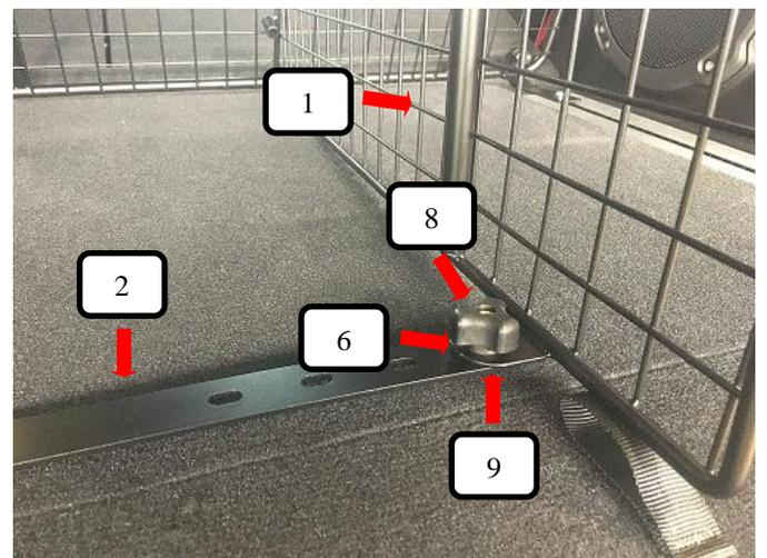
Bodenhalter (Pos. 2) mit einer Schlossschraube (Pos. 9), Unterlegscheibe (Pos. 6) und Rändelmutter flach (Pos. 8) mit dem Raumteiler (Pos. 1) verbinden und festziehen.
