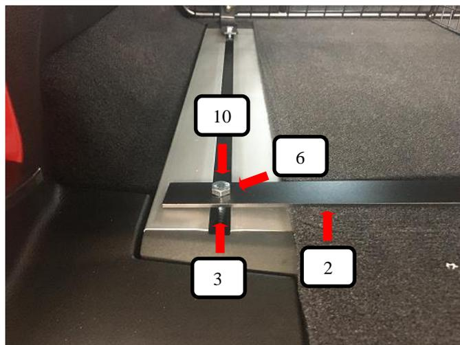
Gegenplatte mit M8 Gewinde (Pos. 3) in die Ladeschiene reinlegen, Maschinenschraube (Pos. 10) und Unterlegscheibe (Pos. 6) durch den Bodenhalter (Pos. 2) stecken und in die Gegenplatte mit M8 Gewinde (Pos. 3) eindrehen und festziehen.
