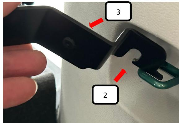
Gummiauflage klein (Pos. 3) von außen in die Seitenhalterung R+L (Pos.2) drücken. Jetzt die Seitenhalterung R+L (Pos.2) wie auf dem Bild in die Verzurröse einklinken.
