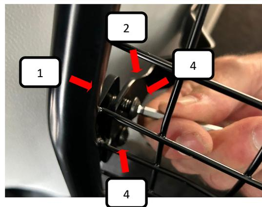
Seitenhalterung R+L (Pos.2) von innen an das Trenngitter (Pos. 1) halten. Jeweils 2 Inbusschrauben M8x10 (Pos. 4) durch die Seitenhalterung R+L (Pos.2) stecken und in das Trenngitter (Pos. 1) schrauben und festziehen.
