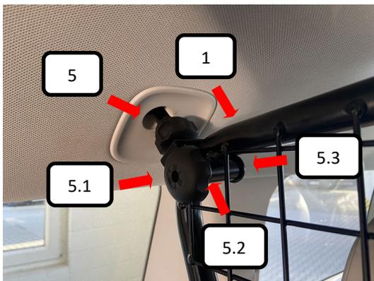
Die Distanzhülse (Pos. 5.4) in das Rohr von Trenngitter (Pos.1) reindrücken und das Trenngitter (Pos. 1) auf beiden Seiten zwischen die Dachverankerung (Pos. 5) führen. Jetzt von vorne die Rundkopfschraube M8x45 (Pos. 5.3) durchstecken, von der anderen Seite eine U-Scheibe (Pos. 5.2) und Rändelmutter (Pos. 5.1) aufschrauben und festziehen.
