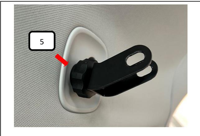
Dachverankerung (Pos. 5) wie auf dem Bild, in die Original-Netzaufhängungen einhängen und festziehen.
