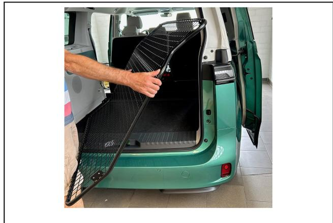
Trenngitter von hinten aus in das Fahrzeug einbringen.
