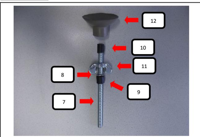
Auf die Gewindestange oben (Pos. 7) die Distanzhülse (Pos. 10) und danach den Gummifuß (Pos. 12) aufstecken. Von der anderen Seite die Flügelmutter (Pos. 11) aufdrehen und dann die U-Scheibe (Pos. 8) und Durchführungsschutzkappe (Pos. 9) aufschieben.
