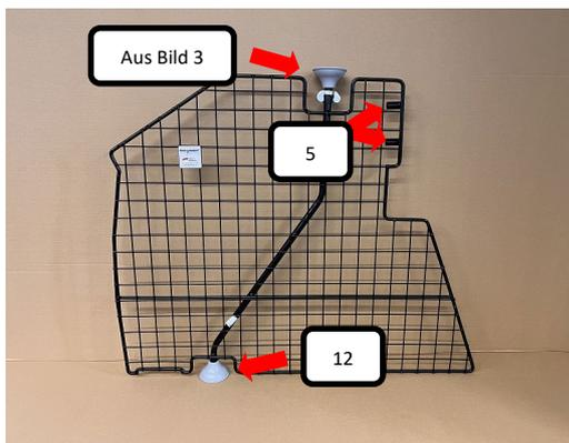
Wie im Bild dargestellt, bitte die aus Bild 3 zusammengesteckte Gewindestange mit Gummifuß oben in die Rohröffnung des Teilers (Pos. 1) stecken (Feststellpunkt) und einen Gummifuß (Pos.12) unten am Teiler aufstecken. Beide Rohrendkappen (Pos. 5) auf den Raumteiler drücken.
