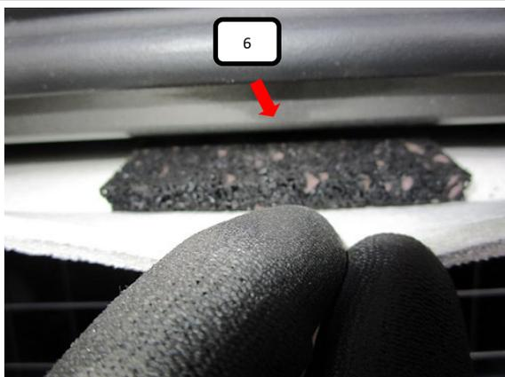
Im oberen Bereich der Heckklappe die Gummiabdichtung leicht anheben und je nach gewünschter Position des Teilers die 2 beigelegten Gummimatten (Pos.6) im Bereich des Feststellpunktes in den Hohlraum schieben.
