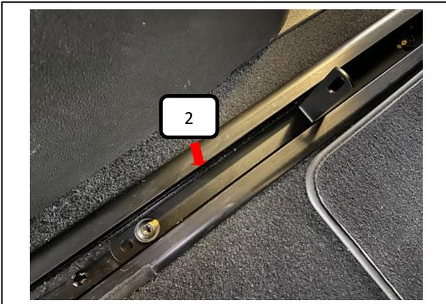
Jetzt den Bodenhalter (Pos. 2) wie auf dem Bild mit der Originalschraube befestigen.
