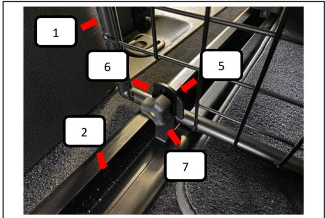
Trenngitter (Pos. 1) von hinten aus in das Fahrzeug einbringen und vor die Bodenhalter (Pos. 2) stellen. Nun das Trenngitter (Pos. 1) und den Bodenhalter (Pos. 2) mittels der Schlossschraube (Pos. 5), Unterlegscheibe (Pos. 6) und Rändelmutter Flach (Pos. 7) befestigen und festziehen.
