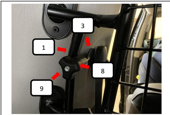
Gewindehaken (Pos. 3) wie auf dem Bild von unten hinter dem Gurt einhängen und durch das Trenngitter (Pos. 1) sowie Kunststoffhülse (Pos. 8) schieben. Jetzt die Rändelmutter gewölbt (Pos. 9) aufschrauben und festziehen.
