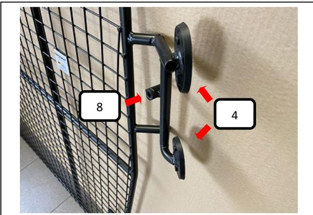
Kunststoffhülse (Pos. 8) in das und Gummiauflage (Pos. 4) auf das Trenngitter (Pos. 1) stecken.
