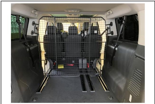
Trenngitter im montierten Zustand.
