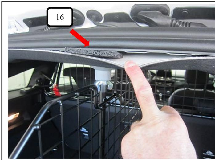
Im oberen Bereich der Hecktür die Gummiabdichtung leicht anheben und je nach gewünschter Position des Teilers 2 x Gummimatte 8mm (Pos.6) im Bereich des Feststellpunktes in den Hohlraum schieben.
