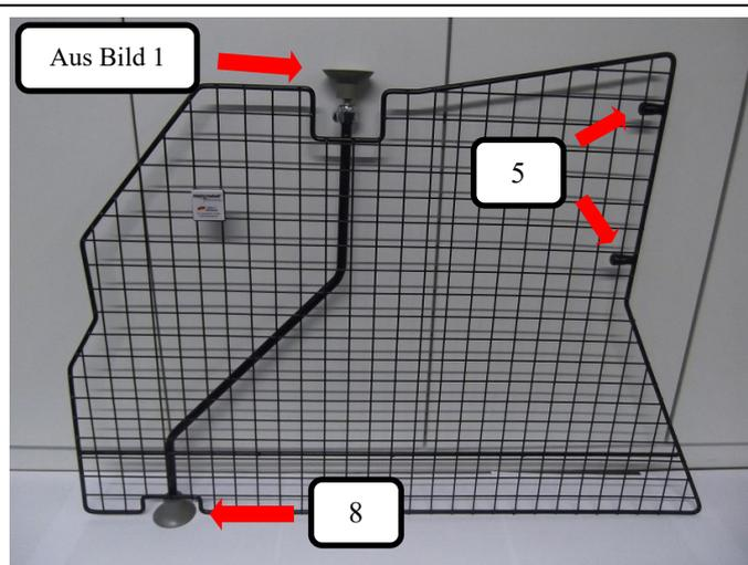
Wie im Bild dargestellt bitte die aus Bild 1 zusammengesteckte Gewindestange mit Gummifuß oben in die Rohröffnung des Teilers stecken (Feststellpunkt) und einen Gummifuß grau RM (Pos.8) unten am Teiler aufstecken. Beide Rohrendkappen (Pos. 5) auf den Teiler drücken.
