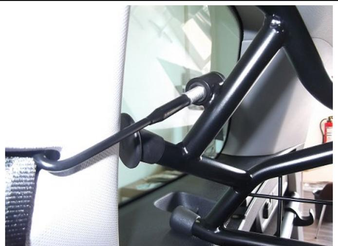
Gewindehaken (Pos. 2) am Gurtschlitz rechts und links einhängen und durch das Trenngitter (Pos. 1) sowie Kunststoffhülse (Pos. 4) stecken.
