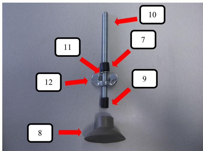
Die Gewindestange oben (Pos.10) auf einen Gummifuß grau (Pos.8) wie im Bild dargestellt aufstecken. Danach die Flügelmutter (Pos. 12) drauf drehen und die Unterlegscheibe (Pos. 11), sowie die Distanzhülse (Pos. 9) aufstecken.
