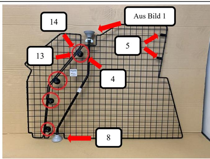
Wie im Bild dargestellt bitte die aus Bild 1 zusammengesteckte Gewindestange mit Gummifuß oben in die Rohröffnung des Teilers stecken (Feststellpunkt) und einen Gummifuß (Pos.8) unten am Teiler aufstecken. Beide Rohrendkappen (Pos. 5) auf den Teiler drücken. Jetzt den Teiler Adapter (Pos. 15) wie auf dem Bild, an den vier rot umkreisten Positionen montieren. Dies mit je einer Rändelschraube (Pos. 13), Unterlegscheibe (Pos. 4) und Rändelmutter flach (Pos. 14).
