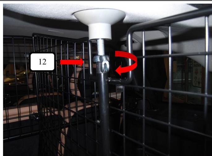
Oberen Feststellunkt über drehen der Flügelmutter (Pos. 12) (Uhrzeigersinn) leicht anziehen.
