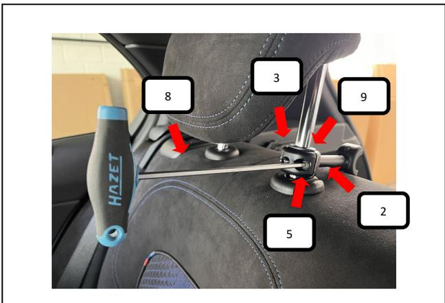
Passende Ausgleichshülse Kopfstützenrohr (Pos.9) um die Kopfstützenstange drücken, jetzt den Montageknochen Mittelelement (Pos. 2) und Klemmringverschluss (Pos. 3) darüber halten und mittels zwei Schrauben M6 (Pos. 5) mit dem Inbusschlüssel 4mm (Pos. 8) befestigen und festziehen.
