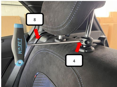
Madenschraube M6 (Pos. 4) mittels des Inbusschlüssel 4mm (Pos. 8) reindrehen und festziehen.
