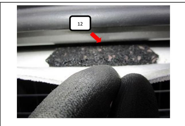
Im oberen Bereich der Heckklappe die Gummiabdichtung leicht anheben und je nach gewünschter Position des Teilers die beigelegte Gummimatte (Pos. 12) im Bereich des Feststellpunktes in den Hohlraum schieben.
