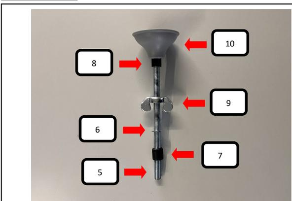
Auf die Gewindestange (Pos. 5) die Distanzhülse (Pos. 8) und danach den Gummifuß (Pos. 10) aufstecken. Von der anderen Seite die Flügelmutter (Pos. 9) aufdrehen und dann die U-Scheibe (Pos. 6) und Durchführungsschutzkappe (Pos. 7) aufschieben
