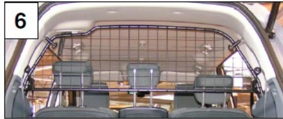
**Hinweis:** Rändelmutter an den Gewindehaken nur so fest anziehen, bis die Auflagen spielfrei anliegen. Bei zu viel Anpressdruck können die Seitenverkleidungen beschädigt werden.
