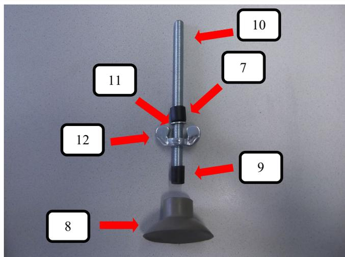
Die Gewindestange oben (Pos.10) mit Distanzhülse (Pos. 9) auf einen Gummifuß grau (Pos.8) wie im Bild dargestellt aufstecken. Danach die Flügelmutter (Pos. 12) drauf drehen und die Unterlegscheibe (Pos. 11), sowie die Distanzhülse (Pos. 7) aufstecken.
