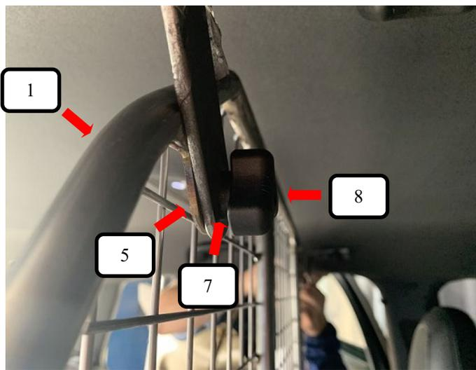
Trenngitter (Pos. 1) wie auf dem Bild an den Dachhalter (Pos. 2) stellen, Schlossschraube (Pos. 5), Unterlegscheibe (Pos. 7) und Rändelmutter flach (Pos. 8) befestigen und festziehen.
