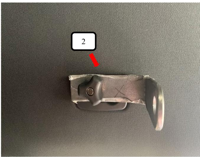
Dachhalter (Pos. 2) wie auf Bild 2 vormontiert, in die Original-Netzaufhängungen einhängen und festziehen.
