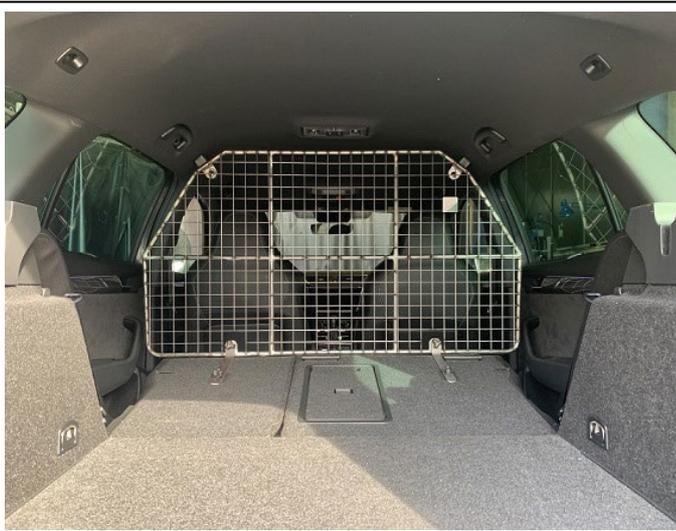
Trenngitter im montierten Zustand.
