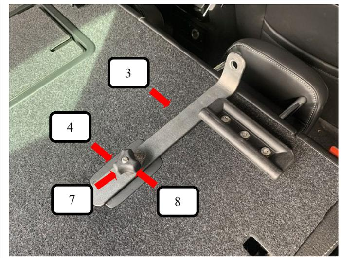
Gewindehaken kurz (Pos. 4) von unten durch den Bodenhalter (Pos. 3) stecken, von oben eine Unterlegscheibe (Pos.7) und Rändelmutter flach (Pos. 8) leicht aufschrauben. Jetzt den Gewindehaken kurz (Pos. 4) in die Isofix-Halterung einhängen und mit der Rändelmutter flach (Pos. 8) festziehen.
