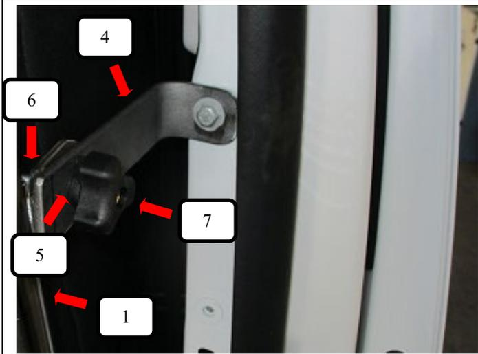
Seitenhalter (Pos. 4) mittels Schlossschraube (Pos. 6), Unterlegscheibe (Pos. 5) und Rändelmutter (Pos. 7) am Trenngitter (Pos. 1) befestigen und festziehen.
