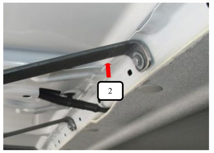
Originalschraube und Unterlegscheibe herausschrauben und die Dachhalter (Pos. 2) mit der originalen Schraube und Unterlegscheibe wie auf dem Bild befestigen.
