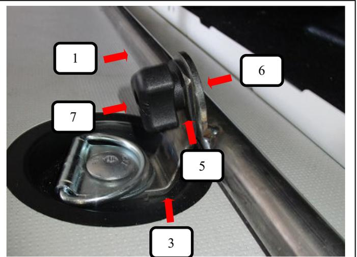
Trenngitter (Pos. 1) von der Seite aus in das Fahrzeug einbringen, die Bodenhalterung (Pos. 3) mittels Schlossschraube (Pos. 6), Unterlegscheibe (Pos. 5) und Rändelmutter (Pos. 7) am Trenngitter (Pos. 1) befestigen und festziehen.
