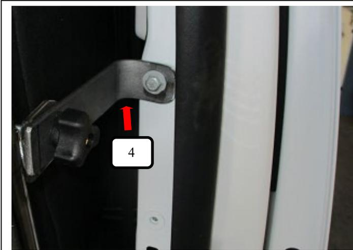
Originalschraube und Unterlegscheibe herausschrauben und die Seitenhalter (Pos. 4) mit der originalen Schraube und Unterlegscheibe wie auf dem Bild befestigen.
