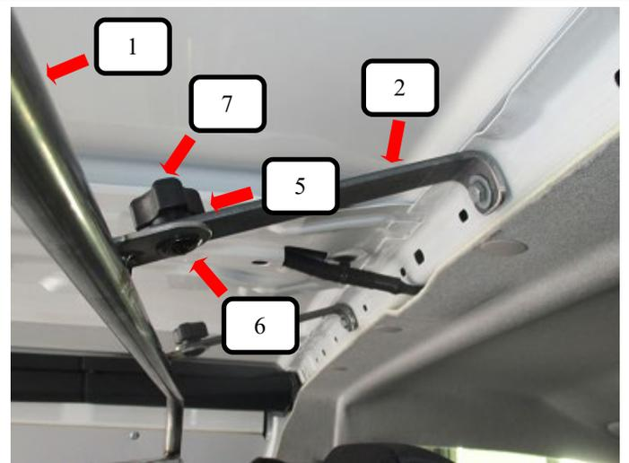
Dachhalter (Pos. 2) mittels Schlossschraube (Pos. 6), Unterlegscheibe (Pos. 5) und Rändelmutter (Pos. 7) am Trenngitter (Pos. 1) befestigen und festziehen.
