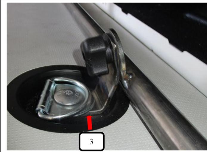
Originalschraube und Verzurröse herausschrauben und die Bodenhalterung (Pos. 3) wie auf dem Bild mit der originalen Schraube und Verzurröse in die vorhandenen originalen Gewinde am Fahrzeug anbringen und festziehen.
