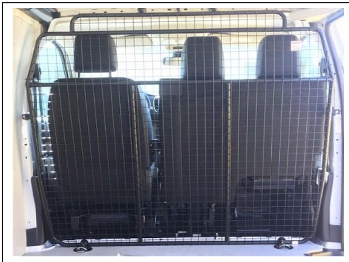
Trenngitter im montierten Zustand.
