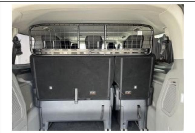
Trenngitter im montierten Zustand.
