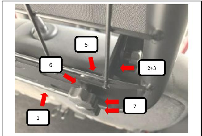
Jetzt das Trenngitter (Pos. 1) vor die montierte Winkelstütze Haken + Klemmbacke (Pos. 2+3) an der äußeren Kopfstütze halten, von vorne eine Rundkopfschraube (Pos. 5) durch die Winkelstütze (Pos. 2+3) und das Trenngitter (Pos. 1) stecken. Jetzt von der anderen Seite eine Unterlegscheibe (Pos. 6) und Rändelmutter (Pos. 7) aufschrauben und festziehen. An der mittleren Kopfstütze ist die gleiche Montage wie auf Bild 4 zu machen.
