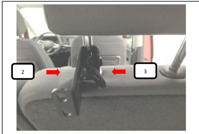
An der mittleren Kopfstütze die Winkelstütze Haken (Pos. 2) wie auf dem Bild um die rechte oder linke Kopfstützenstange führen, jetzt die Winkelstütze Klemmbacke (Pos. 3) in die Winkelstütze Haken (Pos. 2) einklinken.
