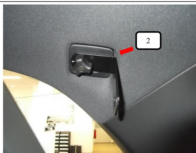
Vormontierten Dachhalter (Pos. 2) in die vorhandenen Netzaufhängungen einhängen und festziehen.
