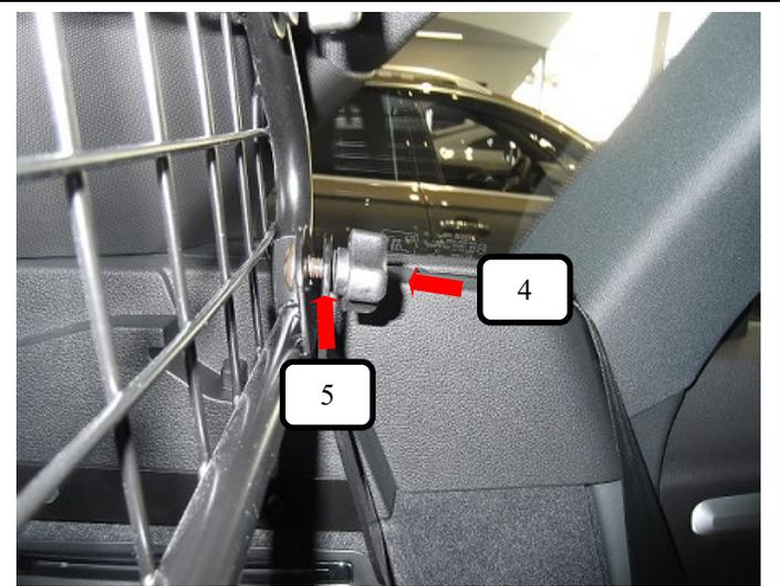
Jetzt von vorne mit der Unterlegscheibe (Pos. 5) und der Rändelmutter flach (Pos. 4) aufschrauben und festziehen.
