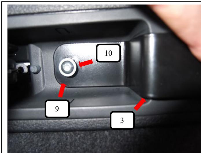
Hebel zurückziehen und Plastikkappe entfernen, darunter befindet sich eine Schraube, die mit einem Torx rausgedreht werden muss. Jetzt die Seitenhalter rechts + links (Pos. 3) ran drücken und mit den Innensechskantschrauben (Pos. 9) und Unterlegscheibe M5 (Pos. 10) festschrauben. Benötigtes Werkzeug: Inbus Gr.3 und Torx Gr. T15
