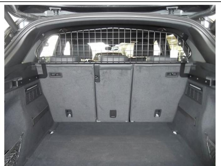
Trenngitter im montierten Zustand.
