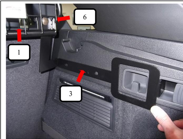
Seitenhalter rechts + links (Pos. 3) auf beiden Seiten von vorne an das Trenngitter (Pos. 1) halten und von hinten die Schlossschraube (Pos. 6) durchstecken.
