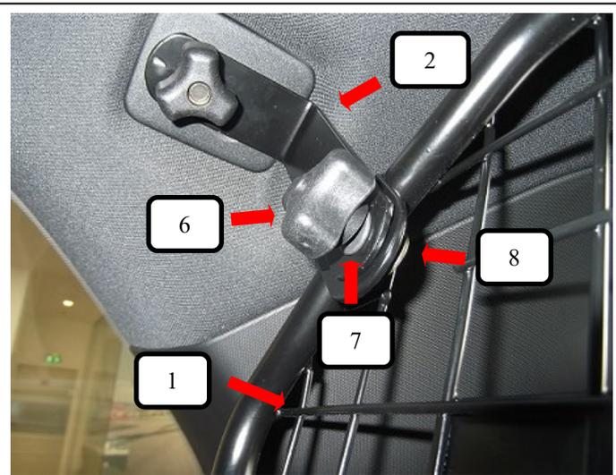
Das Trenngitter (Pos. 1) an den Dachhalter (Pos. 2) halten und die Schlossschraube (Pos. 6) von hinten durchstecken. Von der anderen Seite mit der Unterlegscheibe (Pos. 5) und die Rändelmutter flach (Pos. 4) aufschrauben und festziehen.
