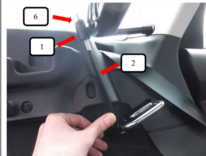
Gewindehaken (Pos. 2) jeweils rechts und links, durch die Kunststoffhülsen (Pos. 6) am Trenngitter (Pos. 1) stecken und unten an der Halterung einhängen.
