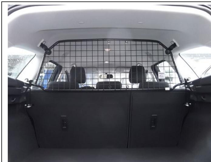
Trenngitter (Pos. 1) im fertig montierten Zustand.
