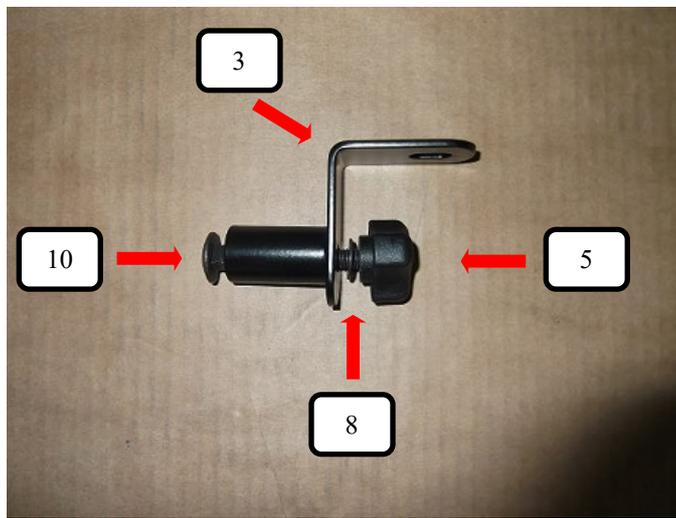
Dachhalter (Pos. 3) wie auf dem Bild mit der Schlossschraube (Pos. 10), Unterlegscheibe (Pos. 8) und Rändelmutter flach (Pos. 5) vormontieren.
