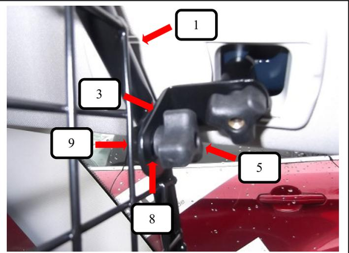
Trenngitter (Pos. 1) vor den montierten Dachhalter (Pos. 3) halten, die Schlossschraube (Pos. 9) von vorne durch das Trenngitter (Pos. 1) und den Dachhalter (Pos. 3) stecken. Jetzt die Unterlegscheibe (Pos. 8) und mit der Rändelmutter flach (Pos. 5) festziehen.
