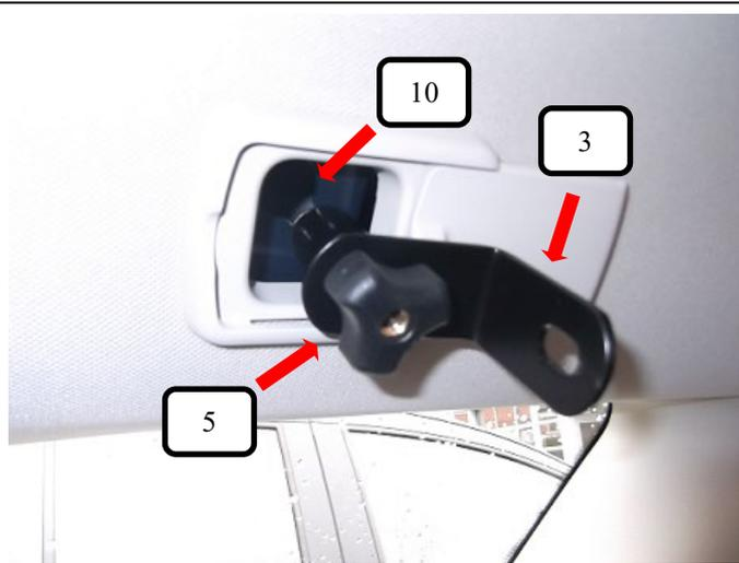
Die auf Bild 1 vormontierten Dachhalter (Pos. 3) mit der Schlossschraube (Pos. 10), in die im Dach enthaltenen Netzaufhängungen (rechts + links) einhängen und mit der Rändelmutter flach (Pos. 5) festziehen.
