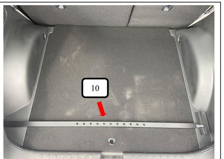
Bodenschiene (Pos. 10) wie auf dem Bild in den Kofferraum positionieren.
