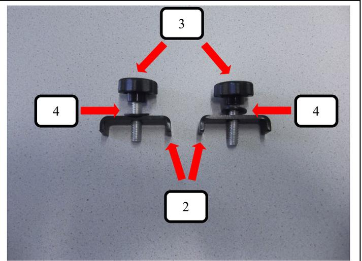
Die beiden U-Bügel (Pos.2) zusammen jeweils einer Unterlegscheibe (Pos.4) und Rändelschraube (Pos.3) wie im Bild dargestellt zusammenbauen.
