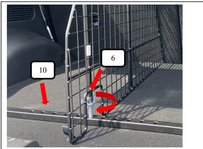
Teiler (Pos. 1) in das Fahrzeug einbringen und an der gewünschten Stelle positionieren. Feststellunkt über drehen der Flügelmutter (Pos. 6) (Uhrzeigersinn) in die Lochbohrung der Bodenschiene (Pos. 10) drehen.
