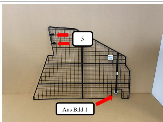
Wie im Bild dargestellt bitte die aus Bild 1 zusammengesteckte Gewindestange unten in die Rohröffnung des Teilers stecken. Beide Rohrendkappen (Pos. 5) auf den Teiler (Pos. 1) drücken.
