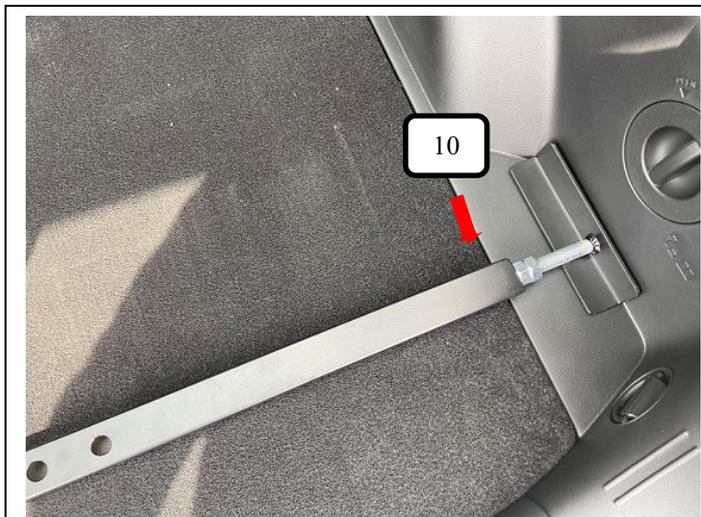
Bodenschiene (Pos. 10) auf der rechten Seite, die erste Mutter mit einem 19er Maulschlüssel die Gewindestange rausdrehen und verspannen. Jetzt die weite Mutter nach ziehen zum Gegenkontern.
