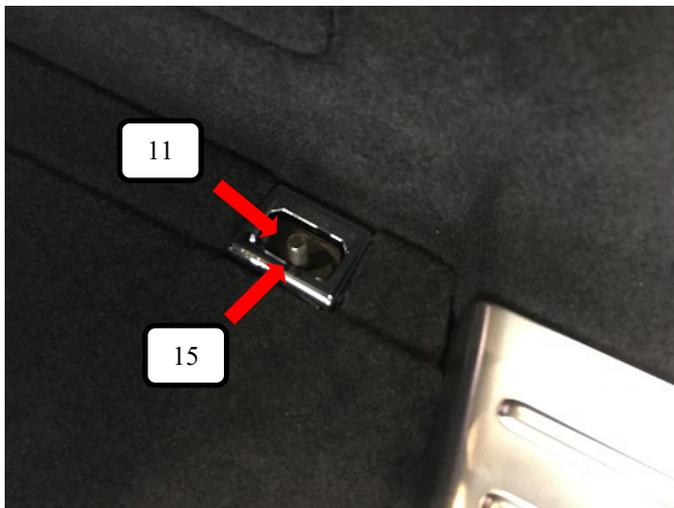
Schlossschraube (Pos. 13) durch die Gegenplatte (Pos. 11) stecken und unter die Verzurröse legen, die Verzurröse dann wieder runter klappen.
