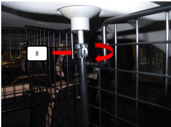
Oberen Feststellunkt über drehen der Flügelmutter (Pos. 8) (Uhrzeigersinn) leicht anziehen.
