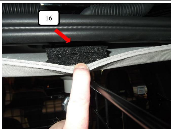
Im oberen Bereich der Hecktür die Gummiabdichtung leicht anheben und je nach gewünschter Position des Teilers die Gummimunterlagen 8mm (Pos.16) im Bereich des Feststellpunktes in den Hohlraum schieben. Bitte die Anzahl der beigelegten Gummimunterlagen 8mm (Pos. 16) verwenden.
