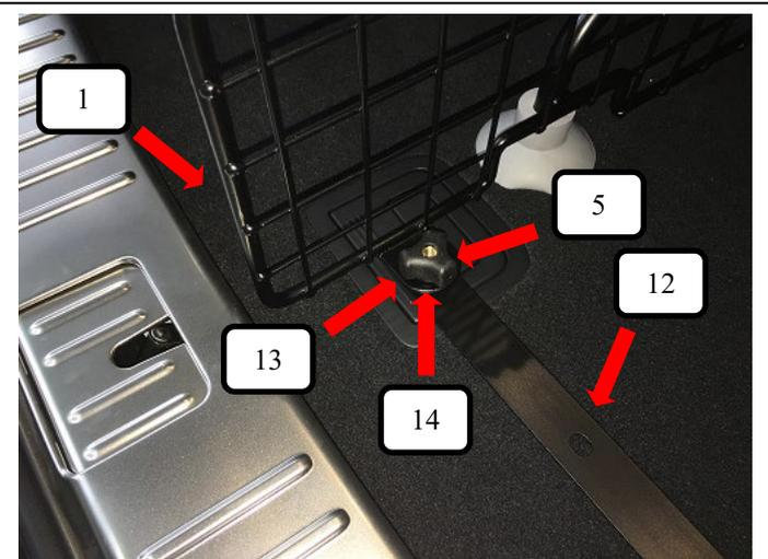
Von unter durch den Bodenhalter (Pos. 12) eine Schlossschraube (Pos. 13) stecken, den Teiler draus stellen und eine Unterlegscheibe (Pos. 5) und Rändelmutter flach (Pos. 14) aufschrauben und festziehen.
