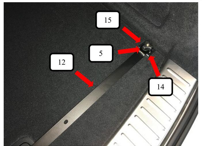
Bodenhalter (Pos. 12) über das Gewinde der Schlossschraube (Pos. 15) setzen, eine Unterlegscheibe (Pos. 5) und Rändelmutter flach (Pos. 14) aufschrauben und festziehen.
