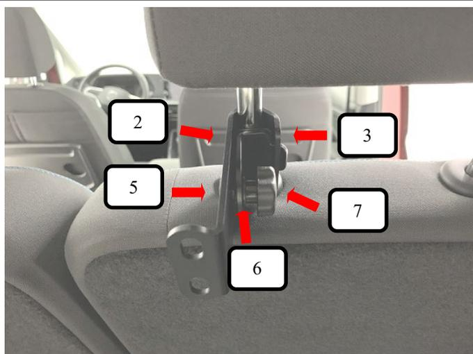
Jetzt an der mittleren Kopfstütze wie auf dem Bild eine Rundkopf-schraube (Pos. 5) durch die Winkelstützen Haken + Klemmbake (Pos. 2 + 3) stecken und von der anderen Seite eine Unterlegscheibe (Pos. 6) und eine Rändelmutter (Pos. 7) aufschrauben und festziehen.
