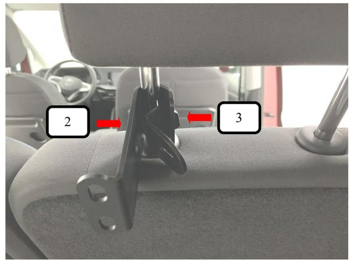
An der mittleren Kopfstütze die Winkelstütze Haken (Pos. 2) wie auf dem Bild um die rechte oder linke Kopfstützenstange führen, jetzt die Winkelstütze Klemmbake (Pos. 3) in die Winkelstütze Haken (Pos. 2) einklinken.
