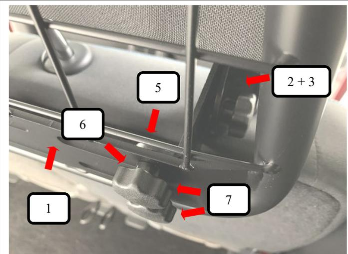
Jetzt das Trenngitter (Pos. 1) vor die montierte Winkelstütze Haken + Klemmbake (Pos. 2+3) an der äußeren Kopfstütze halten, von vorne eine Rundkopfschraube (Pos. 5) durch die Winkelstütze (Pos. 2+3) und das Trenngitter (Pos. 1) stecken. Jetzt von der anderen Seite eine Unterlegscheibe (Pos. 6) und Rändelmutter (Pos. 7) aufschrauben und festziehen.
