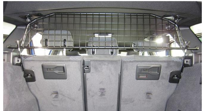
Rücksitze hochklappen, das Trenngitter ausrichten und an den 4 Befestigungspunkten (2x Dachhalter und 2x Gewindehaken) final befestigen.
