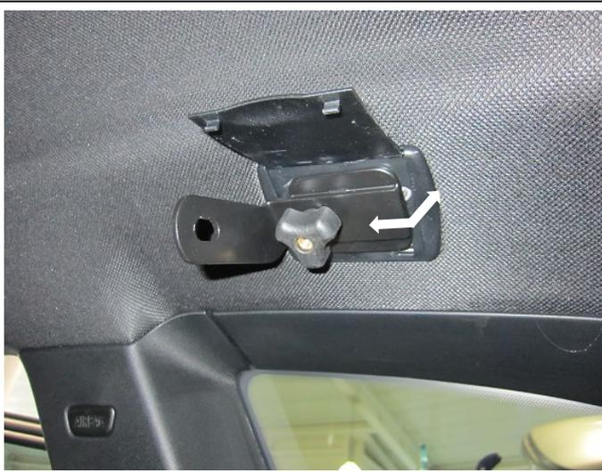
Die aus Bild 2 zusammengebauten Dachbefestigungen L/R jeweils in die Fahrzeugseitigen Netzaufhängungsösen einrasten und wie im Bild dargestellt befestigen.
