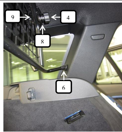
Trenngitter vom Kofferraum aus ins Fahrzeug einbringen zwischen den beiden C-Säulen positionieren, und an den Dachhalter jeweils mit einer Schlossschraube (Pos.9), einer Unterlegscheibe (Pos.8) und Rändelmutter flach (Pos.4) lose befestigen.
