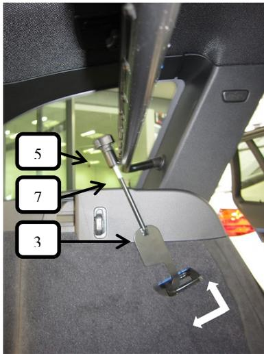
Die beiden Gewindehaken (Pos.3) jeweils links und rechts in die Rücksitzverankerung einhängen, durch die bereits in Bild 1 vormontierte Kunststoffhülse (Pos.7) führen und mit der Rändelmutter gewölbt (Pos.5) leicht befestigen.
