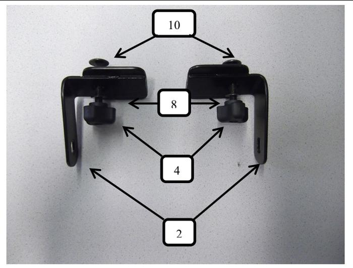
Wie im Bild dargestellt die Dachbefestigung L/R (Pos.2) jeweils zusammen mit einer Schlossschraube (Pos.10), einer Unterlegscheibe (Pos.8) und Rändelmutter flach (Pos.4) lose zusammenschrauben.
