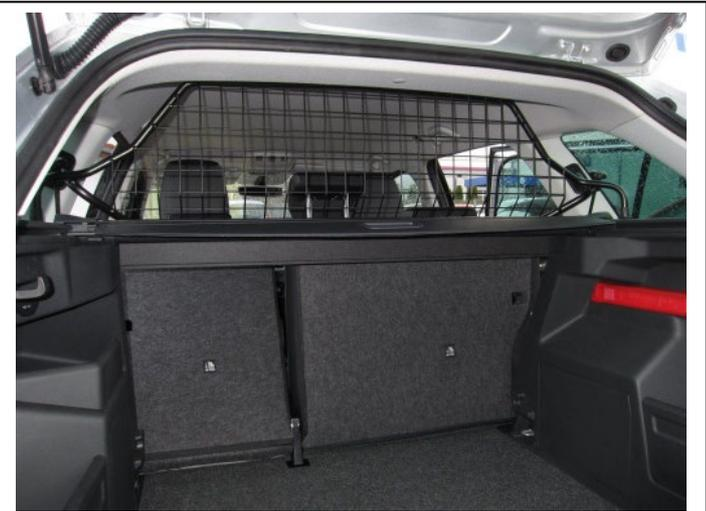
Trenngitter im montierten Zustand.
