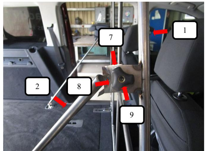
Trenngitter (Pos. 1) in das Fahrzeug einbringen und hinter den Vordersitzen positionieren. Stützstrebe rechts + links (Pos. 2) wie auf dem Bild an das Trenngitter (Pos. 1) halten und von innen eine Rundkopfschraube (Pos. 7) durchstecken. Von der anderen Seite eine Unterlegscheibe (Pos. 8) und Rändelmutter flach (Pos. 9) aufschrauben und festziehen.
