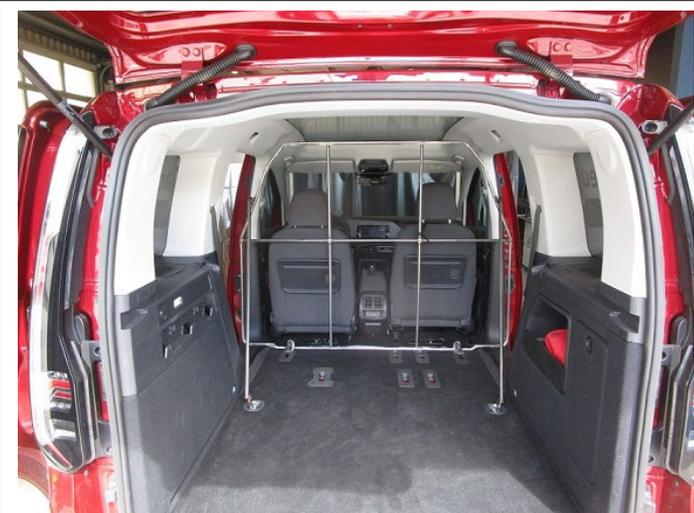
Trenngitter montiert im Fahrzeug.
