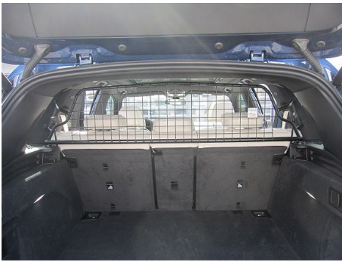
Trenngitter im montierten Zustand.
