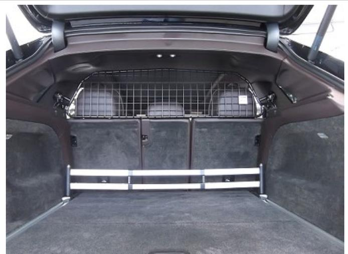
Trenngitter im montierten Zustand.
