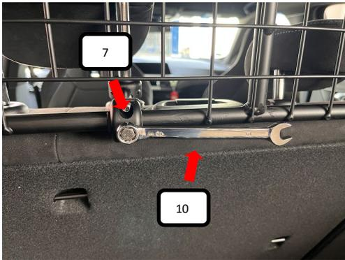
Die Spitzschraube (Pos. 7) mit dem Ring-Gabelschlüssel 10mm (Pos. 10) festziehen.
