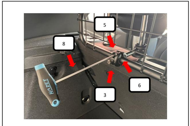
Jetzt den Klemmringverschluss (Pos. 3) mit zwei Schrauben M6 Inbus (Pos. 5), mittels des Inbusschlüssel 4mm (Pos. 5) am Montageknochens Mittelelement (Pos. 2) befestigen und festziehen.
