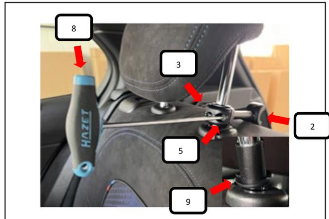
Passende Ausgleichshülse Kopfstützenrohr (Pos.9) um die Kopfstützenstange drücken, breites Ende nach unten (siehe Bild). Jetzt den Montageknochens Mittelelement (Pos. 2) und Klemmringverschluss (Pos. 3) darüber halten und mittels zwei Schrauben M6 (Pos. 5) mit dem Inbusschlüssel 4mm (Pos. 8) befestigen und festziehen.
