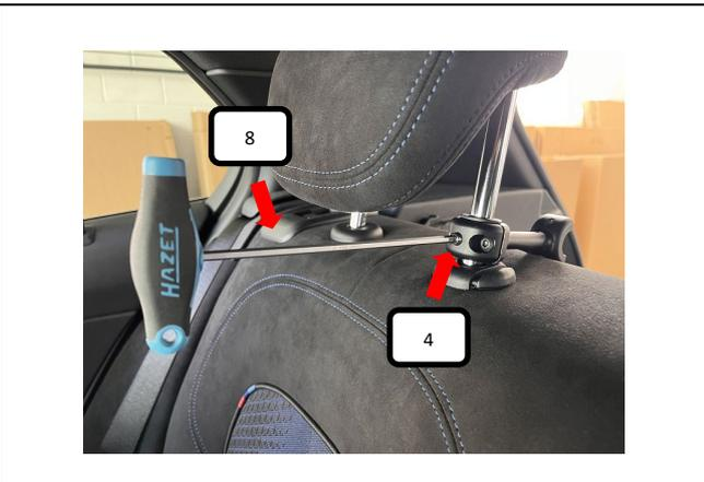
Madenschraube M6 (Pos. 4) mittels des Inbusschlüssel 4mm (Pos. 8) reindrehen und festziehen.
