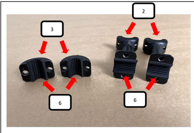
Gummieinlagen (Pos. 6) in die Innenseite des Montageknochens Mittelelement (Pos. 2) und den Klemmringverschluss (Pos. 3) aus Bild 3 drücken.
