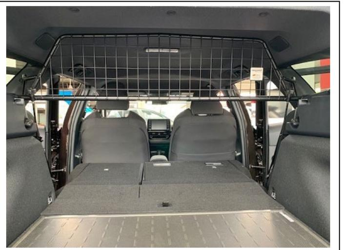
Trenngitter im montierten Zustand.
