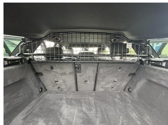
Trenngitter im montierten Zustand.
