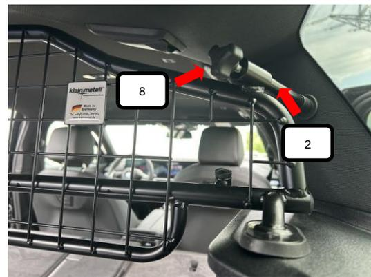
Von der andere Seite die Rändelschraube M8x30 (Pos. 8) in das 16er Rohr mit Innengewinde (Pos. 2) drehen und festziehen.
