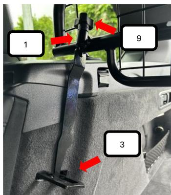
Gewindehaken L+R (Pos. 3) wie auf dem Bild in die Rücksitzbankarretierung einhängen und dann mit dem Gewinde durch das Trenngitter (Pos. 1) schieben. Nun von oben eine Rändelmutter gewölbt (Pos. 9) draufdrehen und festziehen.
