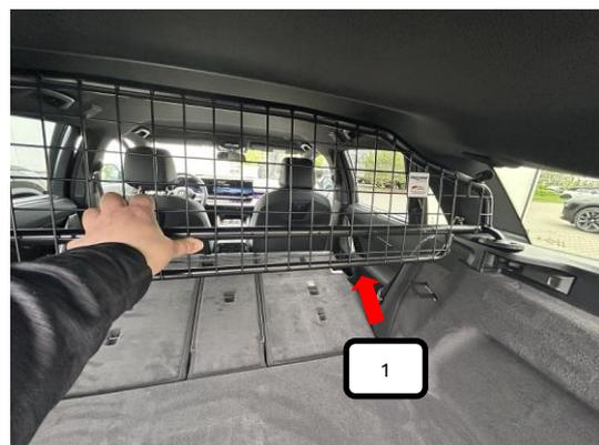
Trenngitter (Pos. 1) von hinten aus in das Fahrzeug einbringen und hinter der C-Säule platzieren.
