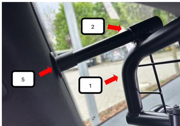
Gummifuß gerade (Pos. 5) auf das 16er Rohr mit Innengewinde (Pos. 2) drücken, darauf achten das es nicht auf der Seite mit dem Innengewinde ist. Jetzt das 16er Rohr mit Innengewinde (Pos. 2) in das Trenngitter (Pos. 1) schieben.
