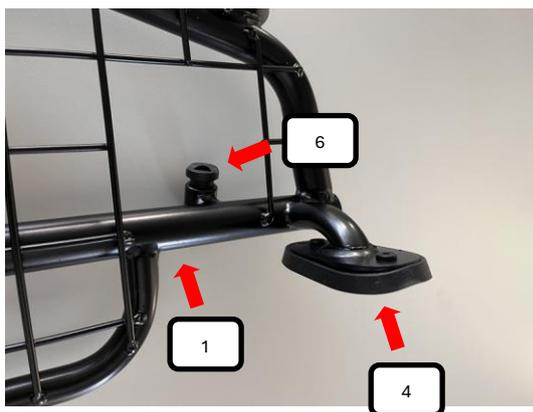
Kunststoffhülse (Pos. 6) in das Trenngitter (Pos. 1) und Gummiauflage (Pos. 4) auf das Trenngitter (Pos. 1) drücken.
