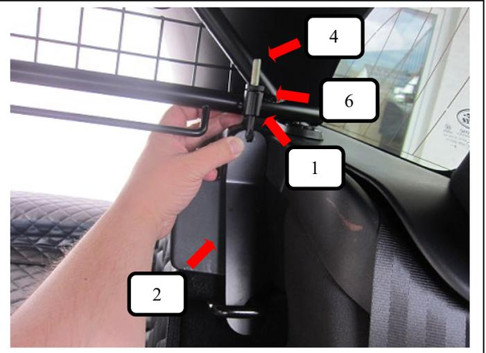
Gewindehaken (Pos. 2) in die Rücksitzbankverankerung einhängen und von unten durch die Kunststoffhülse (Pos. 6) sowie Trenngitter (Pos. 1) schieben. Jetzt die Rändelmutter gewölbt (Pos. 4) aufschrauben und festziehen.
