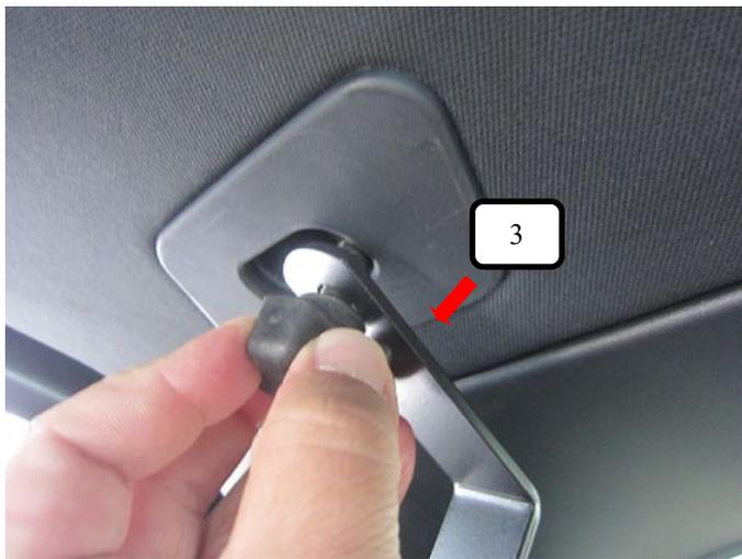
Die aus Bild 2 vormontierten Dachhalter L+R (Pos. 3) in die vorhandenen Netzaufhängungen einhängen und festschrauben.
