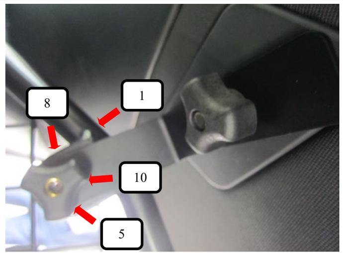
Dachhalter L+R (Pos. 3) mit einer Schlossschraube (Pos. 8), Unterlegscheibe (Pos. 10) und Rändelmutter flach (Pos. 5) am Trenngitter (Pos. 1) befestigen und festziehen.
