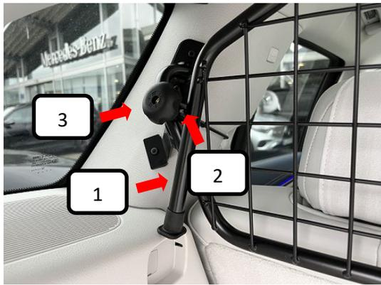
Rändelmutter (Pos. 3) auf den Gewindehaken (Pos. 2) aufschrauben und festziehen.
