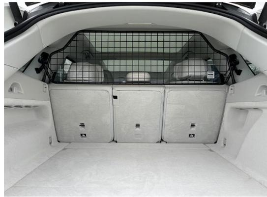
Trenngitter im montierten Zustand.
