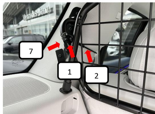
Trenngitter (Pos. 1) von hinten aus in das Fahrzeug einbringen und an der C-Säule positionieren. Jetzt den Gewindehaken (Pos. 2) in den Gurtauswurf einhängen und durch die Kunststoffhülse (Pos. 7) sowie Trenngitter (Pos. 1) führen.
