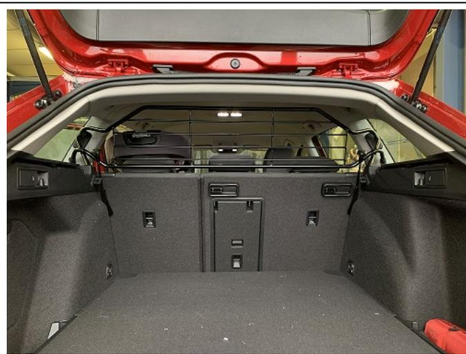
Trenngitter im montierten Zustand.
