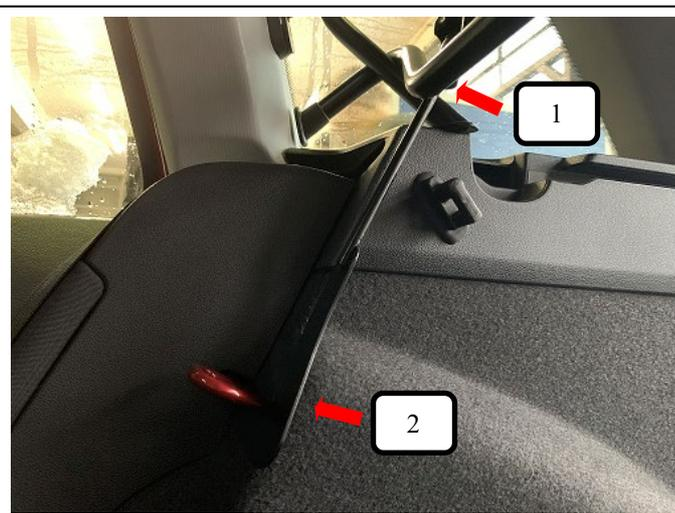
Trenngitter (Pos. 1) von hinten aus in das Fahrzeug einbringen und an der C-Säule positionieren, Gewindehaken (Pos. 2) von unten in die Rücksitzbankarretierung einhängen und oben durch das Trenngitter (Pos. 1) schieben.
