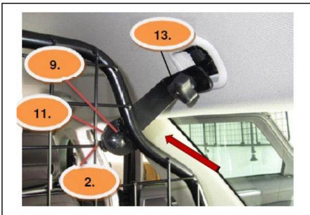
Vormontierte Montagewinkel (Pos. 12 + 13) in die Dachaufnahmen einhängen.
