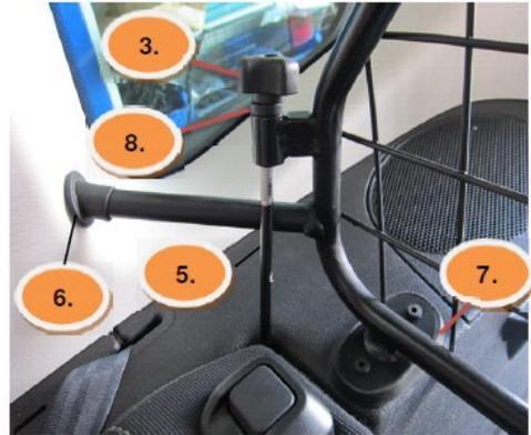
Gewindehaken (Pos. 4 + 5) über die Rücksitzlehnenverankerung schieben und mit dem Gewinde durch die Hülsen am Trenngitter stecken. Jetzt die Rändelmutter gewölbt (3) aufschrauben und festziehen.
