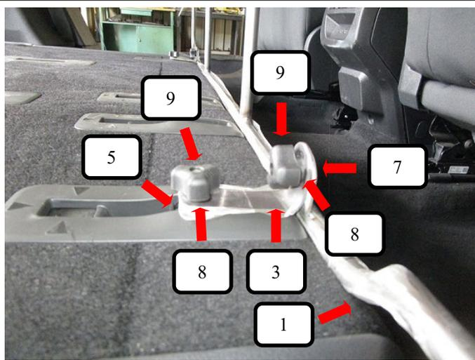
Gewindehaken kurz (Pos. 5) an die Isofix-Verankerung einhängen und durch den Bodenhalter (Pos. 3) stecken, von oben eine Unterlegscheibe (Pos. 8) sowie Rändelmutter flach (Pos. 9) aufschrauben und festziehen. Jetzt von vorne eine Rundkopfschraube (Pos. 7) durch das Trenngitter (Pos. 1) und den Bodenhalter (Pos. 3) stecken, von der anderen Seite eine Unterlegscheibe (Pos. 8) und Rändelmutter flach (Pos. 9) aufschrauben und festziehen.
