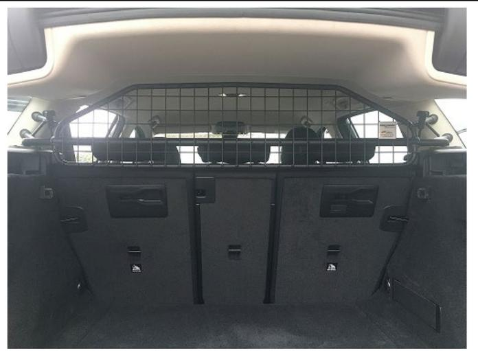
Trenngitter im montierten Zustand.
