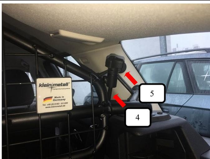
Rändelmutter gewölbt (Pos. 5) auf den Gewindehaken (Pos. 4) aufschrauben und festziehen.
