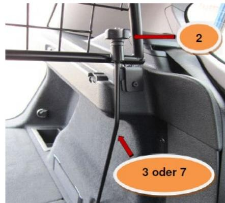
Gewindehaken (Pos. 3) oder (Pos. 7) in die Verzurrsen einhängen und durch die KunststoffhüÙen (Pos. 5) am Trenngitter stecken. Rändelmutter M8 (Pos. 2) aufschrauben und festziehen.
