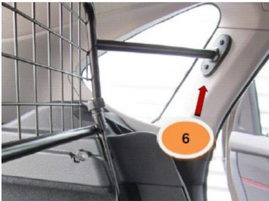
GummifüÙe (Pos. 6) an der C-Säule ausrichten.
