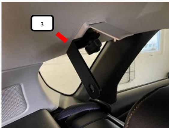
Vormontierte Dachhalter L+R (Pos. 3) aus Bild 3, in die vorhandenen Netzaufhängungen einhängen und festziehen.
