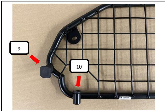
Gummifuß gerade (Pos. 9) auf das Trenngitter (Pos. 1) und Kunststoffhülse (Pos. 10) in das Trenngitter (Pos. 1) stecken.
