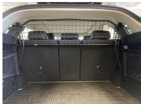
Trenngitter im montierten Zustand.
