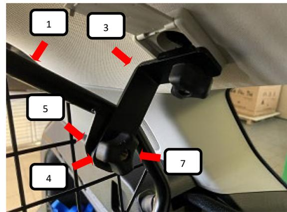
Trenngitter (Pos. 1) in das Fahrzeug einbringen und an den montierten Dachhalter (Pos- 3) halten. Jetzt das Trenngitter (Pos. 1) mittels einer Schlossschraube M8x20 (Pos. 5), Unterlegscheibe (Pos. 7) und Rändelmutter flach (Pos. 7) am Dachhalter (Pos. 3) befestigen und festziehen.
