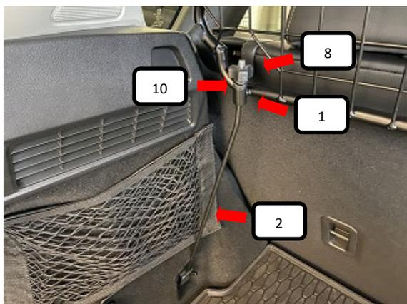
Gewindehaken (Pos. 2) in die Verzurröse einhängen und oben durch das Trenngitter (Pos. 1) sowie Kunststoffhülse (Pos. 10) schieben. Jetzt eine Rändelmutter gewölbt (Pos. 8) aufdrehen und festziehen.
