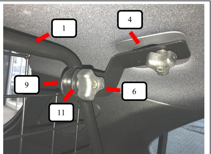
Trenngitter (Pos. 1) von hinten in das Fahrzeug einbringen und an den Dachhalter L + R (Pos. 4) stellen, mit einer Schlossschraube (Pos. 9), Unterlegscheibe (Pos. 11) und Rändelmutter flach (Pos. 6) am Trenngitter (Pos. 1) aufschrauben und festziehen.
