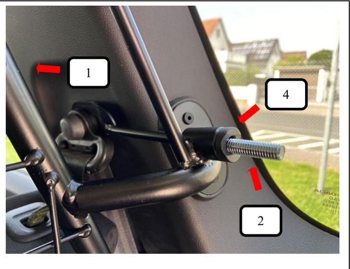
Trenngitter (Pos. 1) in das Fahrzeug einbringen und an der C-Säule platzieren. Jetzt den Gewindehaken L+R (Pos. 2) auf beiden Seiten in die Gutverankerung einhängen und durch die Kunststoffhülse (Pos. 4) sowie Trenngitter (Pos. 1) schieben.
