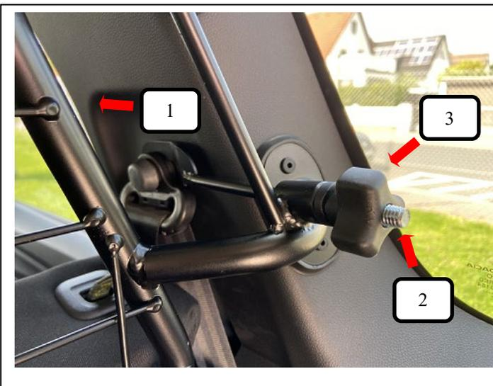
Jetzt auf beiden Seiten eine Rändelmutter gewölbt (Pos. 3) auf die Gewindestangen L+R aufschrauben und festziehen.
