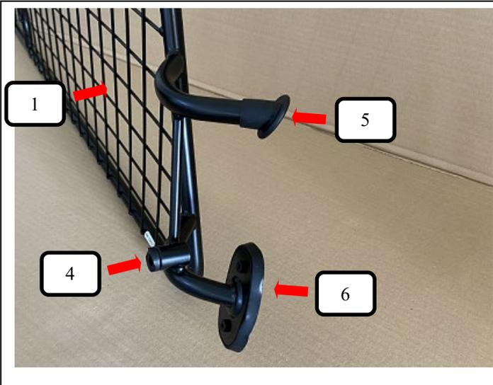
Gummifuß 25° (Pos. 5) sowie Gummiauflage groß (Pos. 6) auf das Trenngitter (Pos. 1) und Kunststoffhülse (Pos. 4) in das Trenngitter (Pos. 1) wie auf dem Bild stecken.
