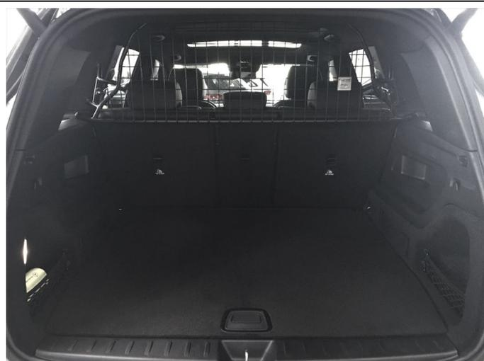
Trenngitter im montierten Zustand.
