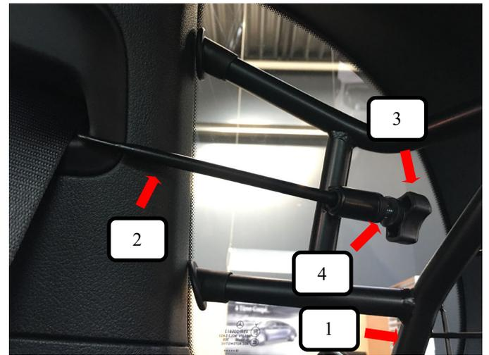
Trenngitter (Pos. 1) von hinten aus schräg in das Fahrzeug einbringen und hinter der C-Säule platzieren. Gewindehaken (Pos. 2) in den Gurtauswurf in der C-Säule einhängen und durch das Trenngitter (Pos. 1) sowie Kunststoffhülse (Pos. 4) führen. Jetzt die Rändelmutter flach (Pos. 3) aufschrauben und festziehen.
