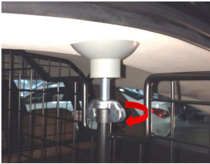
Oberen Feststellpunkt über drehen der Flügelschraube (Uhrzeigersinn) anziehen. **Achtung ! Feststellpunkt am Dachhimmel nicht zu fest anziehen, da Deformationen und Beschädigungen im Bereich des Dachhimmels möglich sind !**
