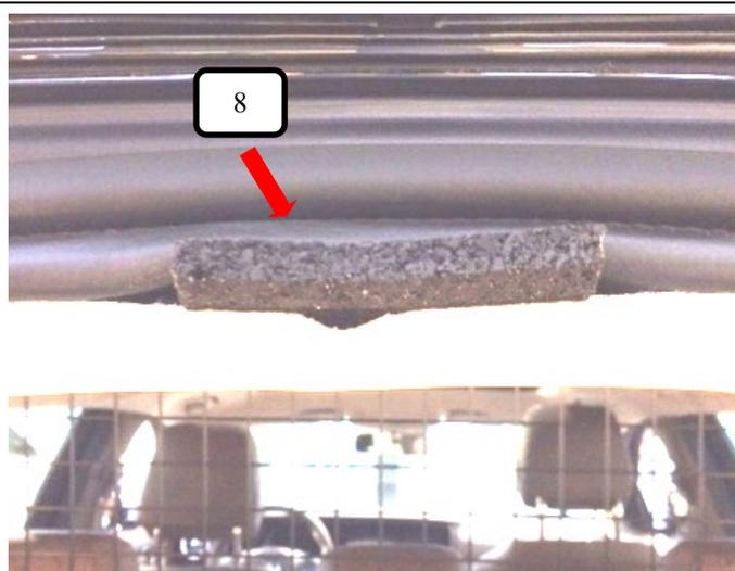
1 Gummiauflage 8mm (Pos. 8) unter den Dachhimmel klemmen.
