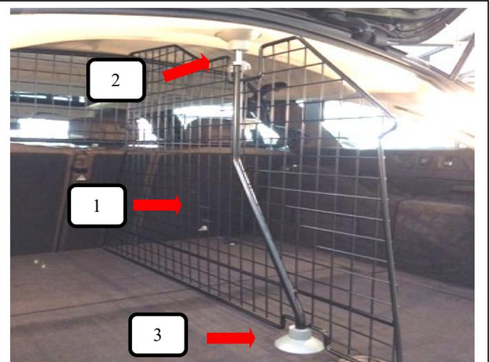
Gewindestange wie auf Bild 1 vormontiert, oben in das Trenngitter (Pos. 1), sowie einen Gummifuss (Pos. 3) unten an das Trenngitter (Pos. 1) stecken.
