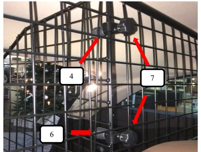
Raumteiler (Pos. 1) in das Fahrzeug stellen, nun den Raumteiler (Pos. 1) mittels der beiden Verschraubungen aus Bild 2 oben und unten am Trenngitter befestigen. Das Ende der Gewindebuchse mit den Rohrendkappen (Pos. 6) schützen.
