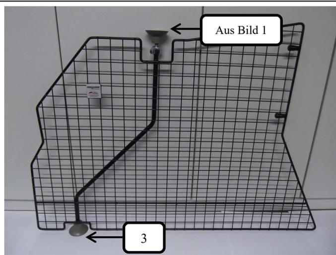
Wie im Bild dargestellt bitte die aus Bild 1 zusammengesteckte Gewindestange mit Gummifuss oben in die Rohröffnung des Teilers stecken (Feststellpunkt) und einen Gummifuss (Pos.3) unten am Teiler aufstecken.
