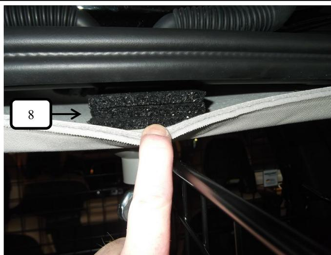
Im oberen Bereich der Hecktür die Gummiabdichtung leicht anheben und je nach gewünschter Position des Teilers die Gummimunterlagen 8mm (Pos.8) im Bereich des Feststellpunktes in den Hohlraum schieben.
