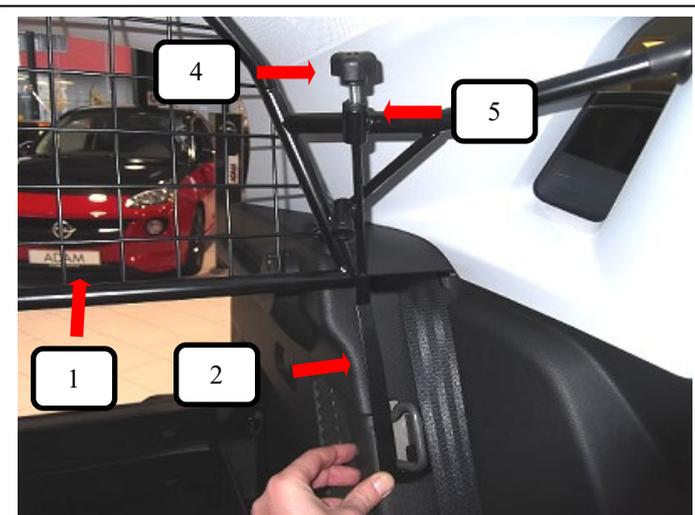
Gewindehaken L & R gekrümmt (Pos. 2) von unten an die Rücksitzbankarretierungspunkte halten und durch die Kunststoffhülse (Pos. 5) führen. Rändelmutter (Pos. 4) aufschrauben bis das Trenngitter (Pos. 1) spielfrei sitzt.
