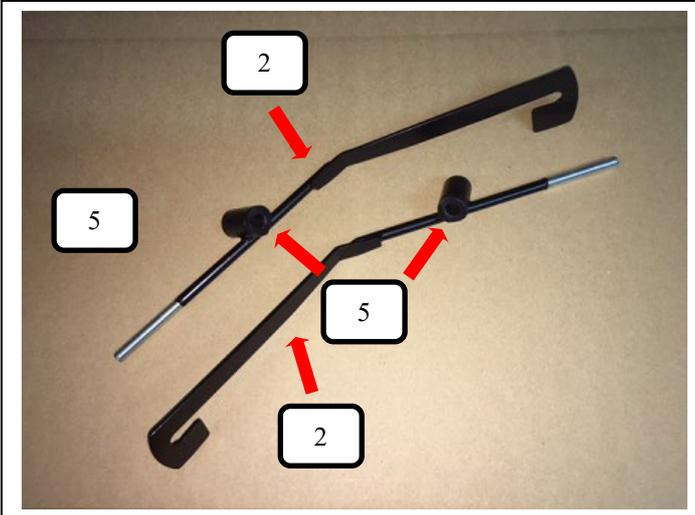
Kunststoffhülsen (Pos. 5) wie auf dem Bild 1, in die Gewindehaken L & R gekrümmt stecken.
