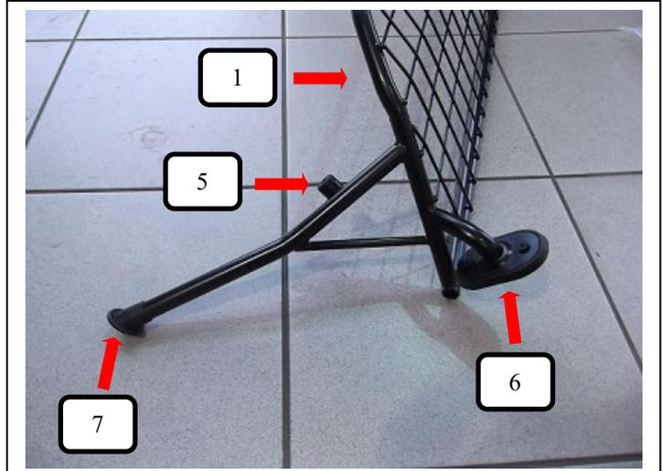
Schutzkappe (Pos. 7) und Gummifuß (Pos. 6) auf das Trenngitter (Pos. 1) und Kunststoffhülse (Pos. 5) in das Trenngitter (Pos. 1) stecken. Danach das Trenngitter (Pos. 1) in das Fahrzeug einbringen.
