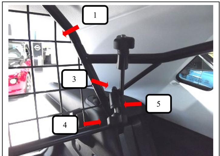
Gewindehaken (Pos. 3) von oben durch das Trenngitter (Pos. 1) und Kunststoffhülse (Pos. 5) stecken. Der Gewindehaken (Pos. 3) muss sich am Trenngitter (Pos. 1) einhaken. Dann von unten die Rändelmutter (Pos. 4) drauf drehen und festziehen.
