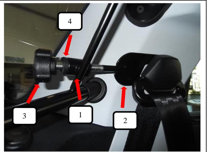
Das Trenngitter (Pos. 1) in das Fahrzeug stellen, so dass es sich an der C-Säule abstützt. Den Gewindehaken (Pos. 2) an der Gurthalterung eingehängen und durch das Trenngitter (Pos. 1) und die Kunststoffhülse (Pos. 4) stecken. Jetzt die Rändelmutter gewölbt (Pos. 3) auf den Gewindehaken (Pos. 2) drehen und anziehen.
