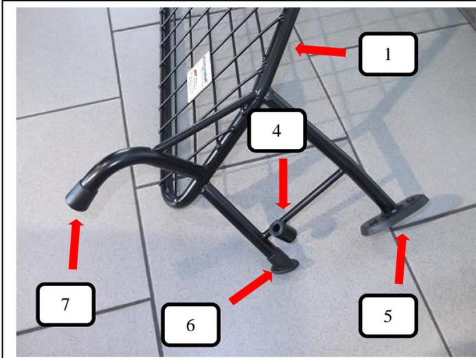
Die Schutzkappen 25° (Pos. 6), Rohrendkappen 16mm (Pos. 7) und die Gummifüße (Pos. 5) auf das Trenngitter (Pos. 1) stecken. Die Kunststoffhülsen (Pos. 4) werden in das Trenngitter (Pos. 1) gedrückt.
