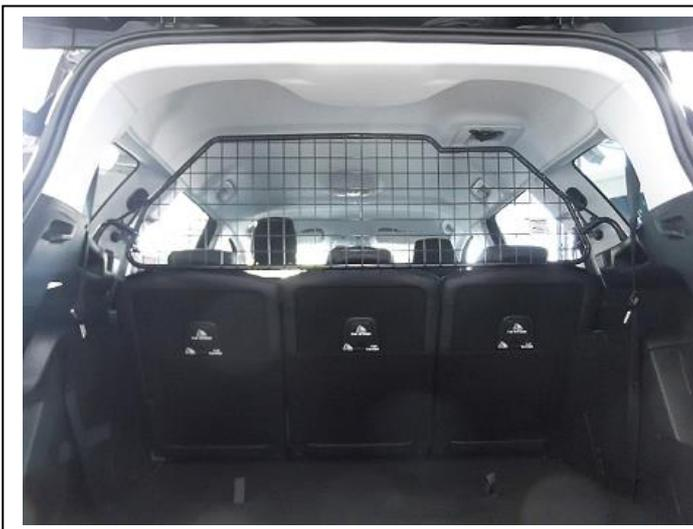
Trenngitter (Pos. 1) fertig montiert.
