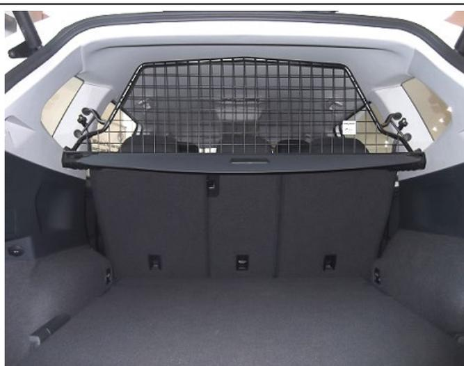
Trenngitter im montierten Zustand.
