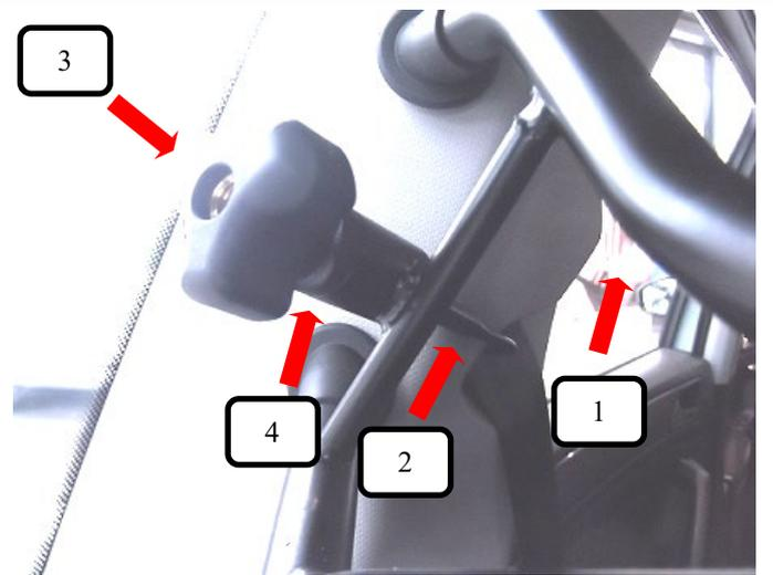
Trenngitter (Pos. 1) in das Fahrzeug einbringen, den Gewindehaken (Pos. 2) am Gurtschlitz rechts und links einhängen und durch das Trenngitter (Pos. 1) sowie Kunststoffhülse (Pos. 4) stecken. Rändelmutter gewölbt (Pos. 3) aufschrauben und festziehen.
