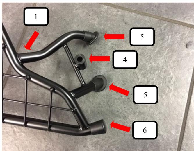
Schutzkappe 25° (Pos. 5) und Endkappe 16mm (Pos. 6) auf das Trenngitter (Pos. 1) und Kunststoffhülsen (Pos. 4) in das Trenngitter (Pos. 1) stecken.
