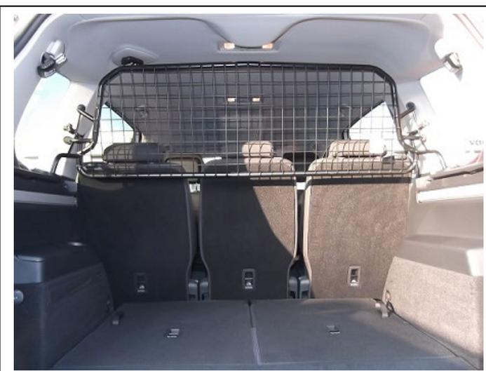
Trenngitter (Pos. 1) im montierten Zustand.
