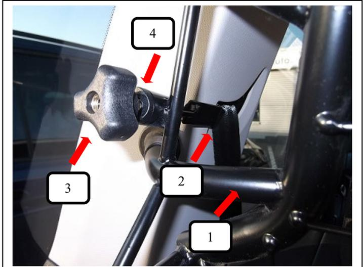
Trenngitter (Pos. 1) in das Fahrzeug einbringen und gegen die C-Säule lehnen. Gewindehaken (Pos. 2) am Gurtauswurfschlitz einhängen, durch das Trenngitter (Pos. 1) mit der Kunststoffhülse (Pos. 4) durchführen und eine Rändelmutter (Pos. 3) aufschrauben und festziehen.
