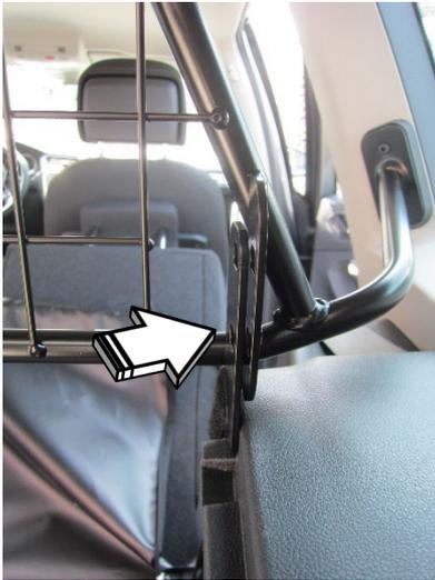
Montagestreben Pos.7&8 unter dem Trenngitter nach hinten, und zur Seite (Seitenverkleidung) schwenken.
