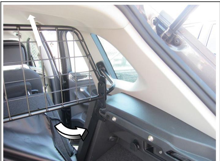
Montagestreben Pos.7&8 unter dem Trenngitter nach hinten, und zur Seite schwenken (zur Seitenverkleidung). **Dieser Montageschritt sollte mit zwei Personen durchgeführt werden!**
