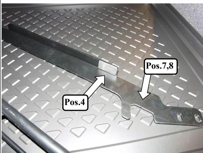
Gummiauflagen Pos.4 mit dem Zapfen in die Bohrungen der Montagestreben Pos.7 & 8 drücken.
