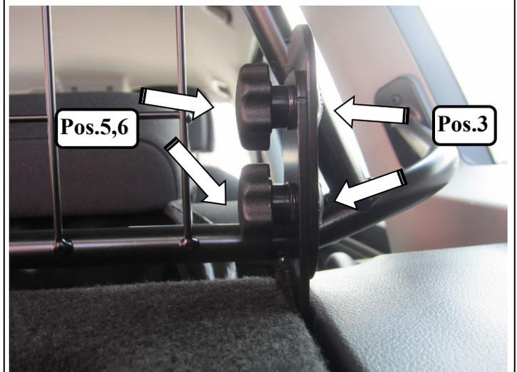
Streben Pos. 7&8 mit Rundkopfschrauben Pos. 3, Rändelmuttern Pos. 6, und U-Scheiben Pos.5 montieren. Trenngitter nach vorne drücken, und dann die Schrauben richtig anziehen. Das Gitter soll sich so gegen die C-Säulenverkleidung verspannen.
