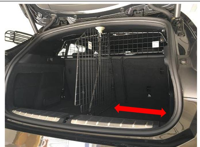
Teiler ggf. leicht ausrichten und final befestigen.
