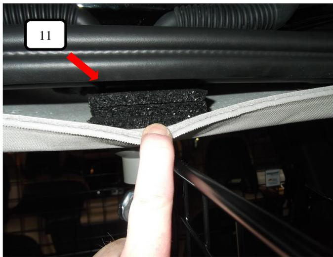
Im oberen Bereich der Hecktür die Gummiabdichtung leicht anheben und je nach gewünschter Position des Teilers die Gummimunterlagen 8mm (Pos.11) im Bereich des Feststellpunktes in den Hohlraum schieben.
