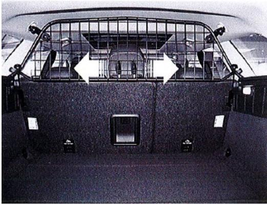
Trenngitter gleichmäßig ausrichten und Rändelmuttern anziehen, bis das Trenngitter spielfrei sitzt. Vor dem Einrasten der Rückenlehne entscheiden, ob die mittlere Kopfstütze aufgestellt sein soll. Nach dem Einrasten ist dies nicht möglich.
