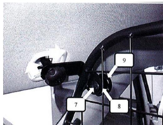
Rundkopfschraube (Pos. 6) in die Aufnahme im Dach einhängen und locker am Trenngitter (Pos. 1) verschrauben.
