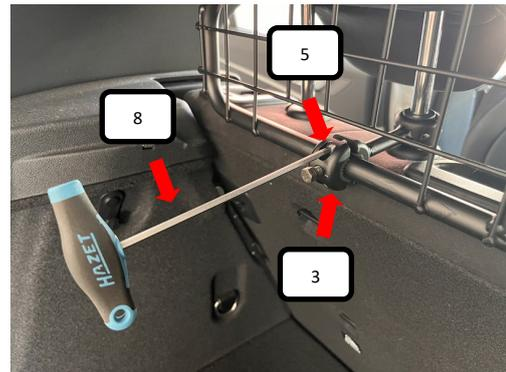
Jetzt den Klemmringverschluss (Pos. 3) mit zwei Schrauben M6 Inbus (Pos. 5), mittels des Inbusschlüssel 4mm (Pos. 5) am Montageknochen Mittelelement (Pos. 2) befestigen und festziehen.
